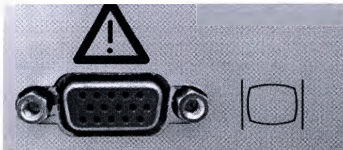
Рисунок 8: VGA-разъем для подключения внешнего монитора (дооснащение)
