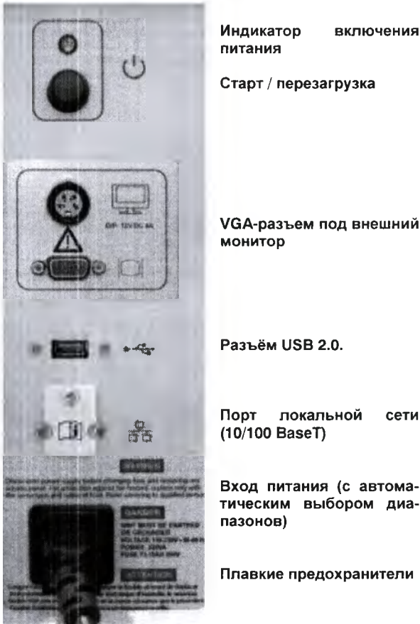
Рисунок 6: Соединительные порты на вычислительном блоке
