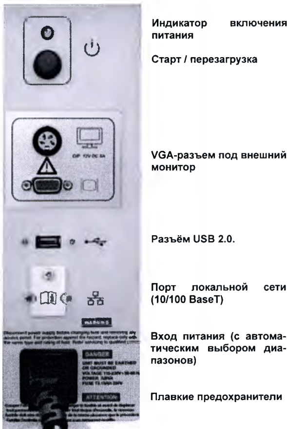
Рисунок 6: Соединительные порты на вычислительном блоке
