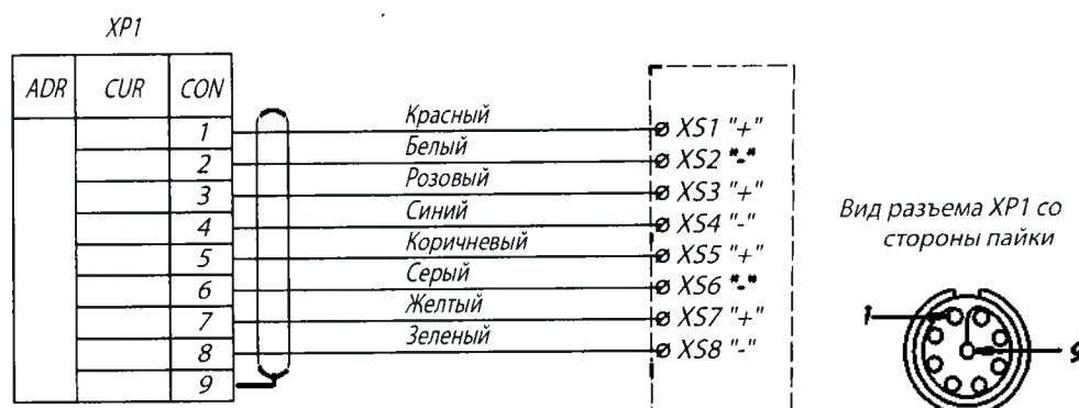
Рис. 15. Схема электрическая принципиальная кабеля выносного блока для подключения стимулирующих электродов.
