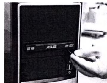
Рис. 9. Аварийное открытие лотка дисковода.
