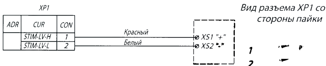
Рис. 16. Схема электрическая кабеля выносного блока для подключения электродов для прямой стимуляции нервов.
