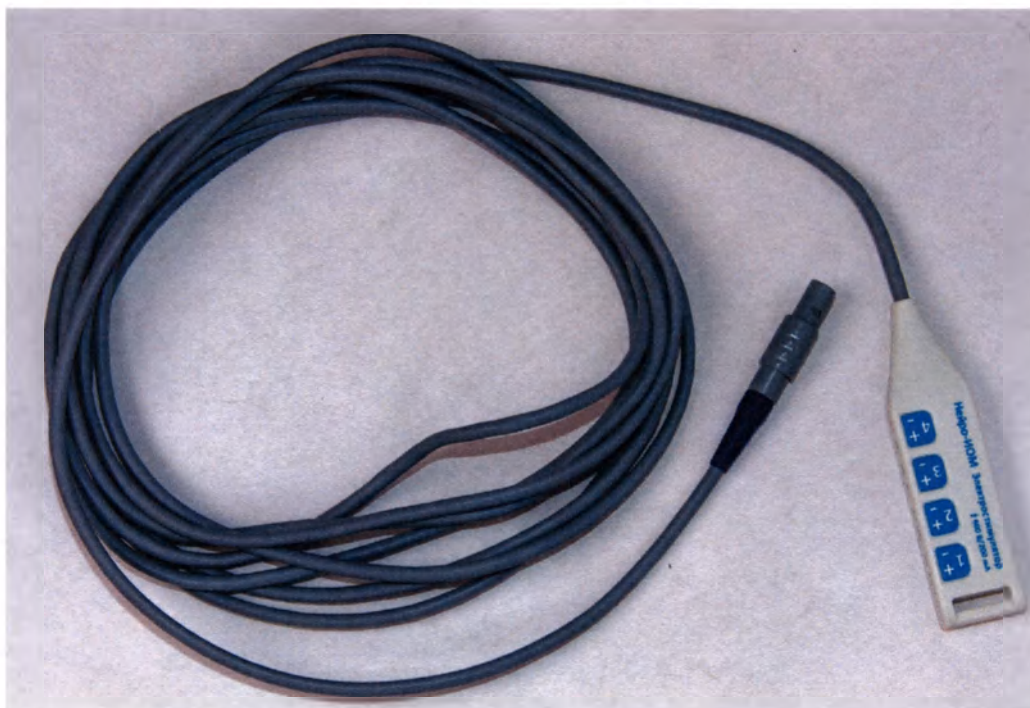
Выносной блок для подключения стимулирующих электродов 1-4
