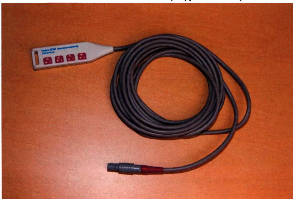
Выносной блок для подключения стимулирующих электродов 5-8
