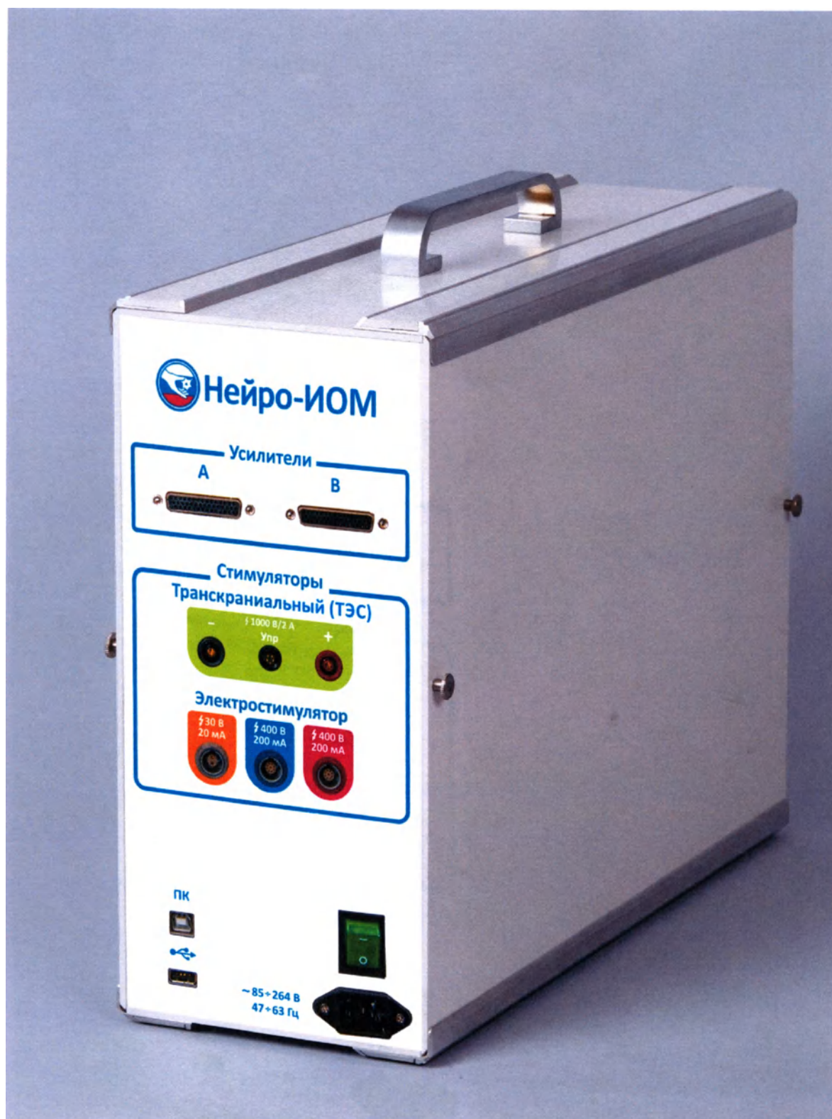
Электронный блок «Нейро-ИОМ» (NS073201.002-011, NS073201.004-01)
