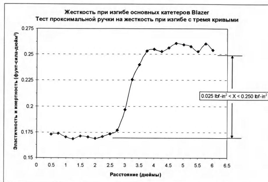
График 1. Пример кривой жесткости при изгибе ( E \cdot I ) в сравнении с расстоянием на катетере.
