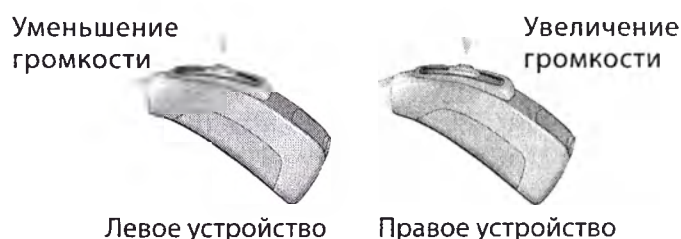
Рисунок 10 – Регулировка громкости в СА «Сакура S»
