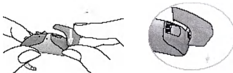
Рисунок 14 – Подключение адаптера типа «Башмак»
