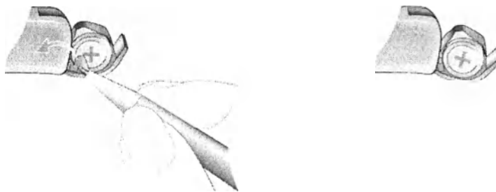
Рисунок 5 – Установка элемента питания в СА
