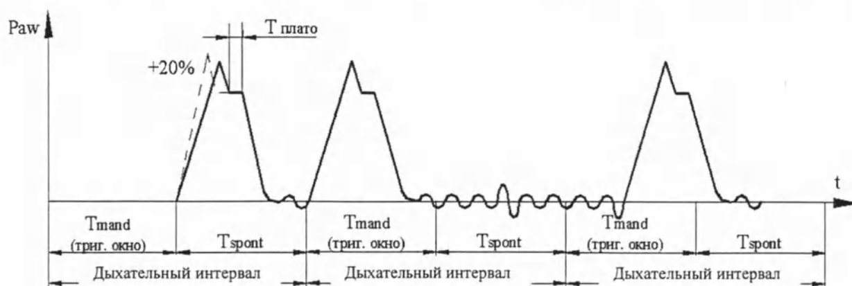
Рисунок 25 – График дыхательного цикла режима SIMV
