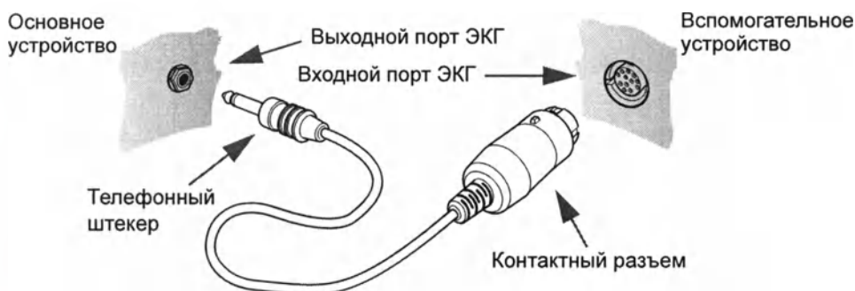
Рис. 20 Подключение выходного кабеля ЭКГ
