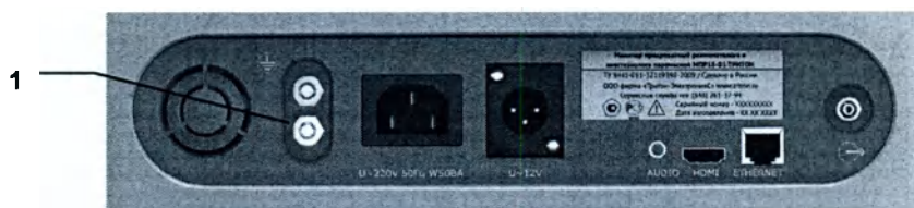
1 – зажим выравнивания потенциалов, 2 – зажим защитного заземления
