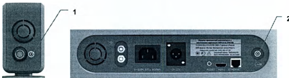
Рисунок 3.33 – Штуцер выхода газа модуля газоанализа
