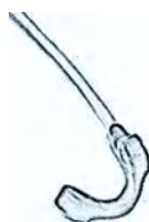
Рисунок 3.17 – Чрезмерно раскрытый датчик
