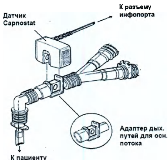
Рисунок 3.56 – Схема подключения модуля капнографа прямого потока
