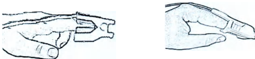
Рисунок 3.13 – Пальцевые датчики («прищепка» и резиновый)
