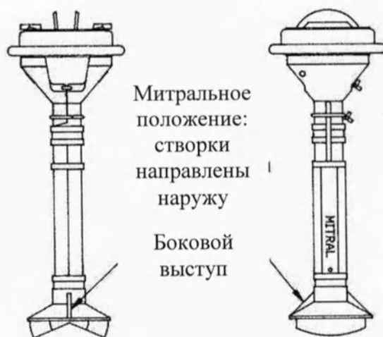
РИСУНОК 6. Держатель механического митрального клапана и ручка/ротатор в сборе Митральное положение: створки направлены наружу
